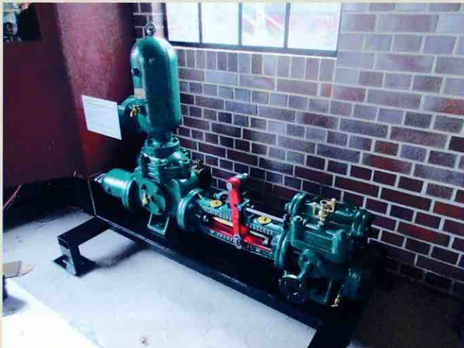
Simplex Dampfpumpe, KSB Frankenthal Bj. 1913
