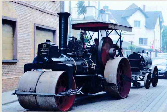
2 Zyl. Verbund Dampfwalze ( 15 t ), Ohl, Limburg Bj. 1909
