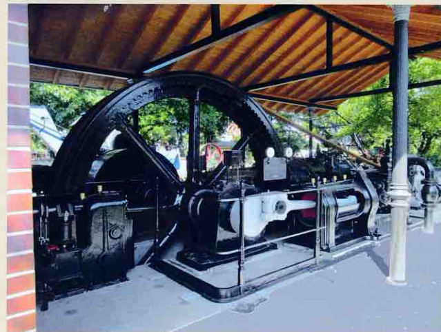
Tandemdampfmaschine mit Linde Kältemaschine, MAN Bj. 1910
